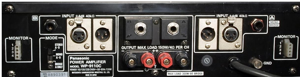
Gut bestückt und klar beschriftet, älteres 2HE-150 Watt-Stereo Modell ohne Speakon-Anschlüsse. Bridge Modus bedeutet, beide Kanäle zusammen als einen zu betreiben, als Monoendstufe, praktisch für einen kleinen Subwoofer.
