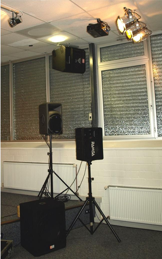
Die erste Top-Box ist zu hoch und soll mehr nach innen und unten geneigt werden, so wie die Ramsa Box. Dann wird der Schall zielgerichtet auf die Sitzplätze fokussiert mit weniger Seitenreflektionen von den Fenstern und die Boxen können auch leise sein. Die Bassbox steht hier richtig unter der Top-Box auf festem Boden.
