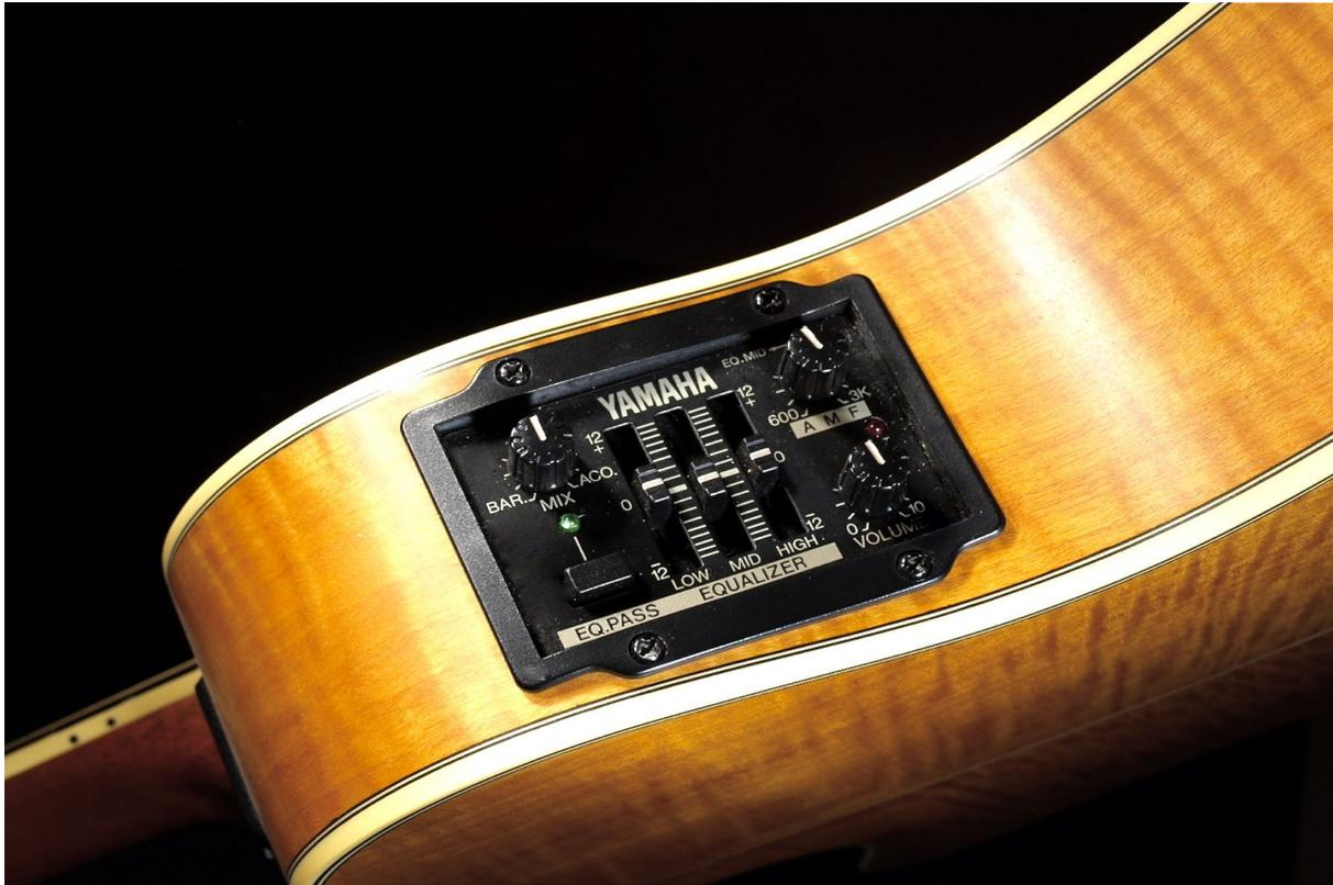
Bei der Yamaha APX Serie gibt es die Möglichkeit stufenlos zwischen dem eingebauten Kondensatormikro („ACO“) und dem Piezotonabnehmer („BAR“) zu mischen. Dazu kommt eine halbparametrische Klangregelung und der Klang ist gerade für Bühneneinsatz hervorragend.
